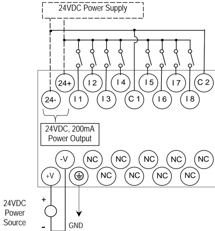
9.5.4 Wiring Diagram, IC200UEI016
